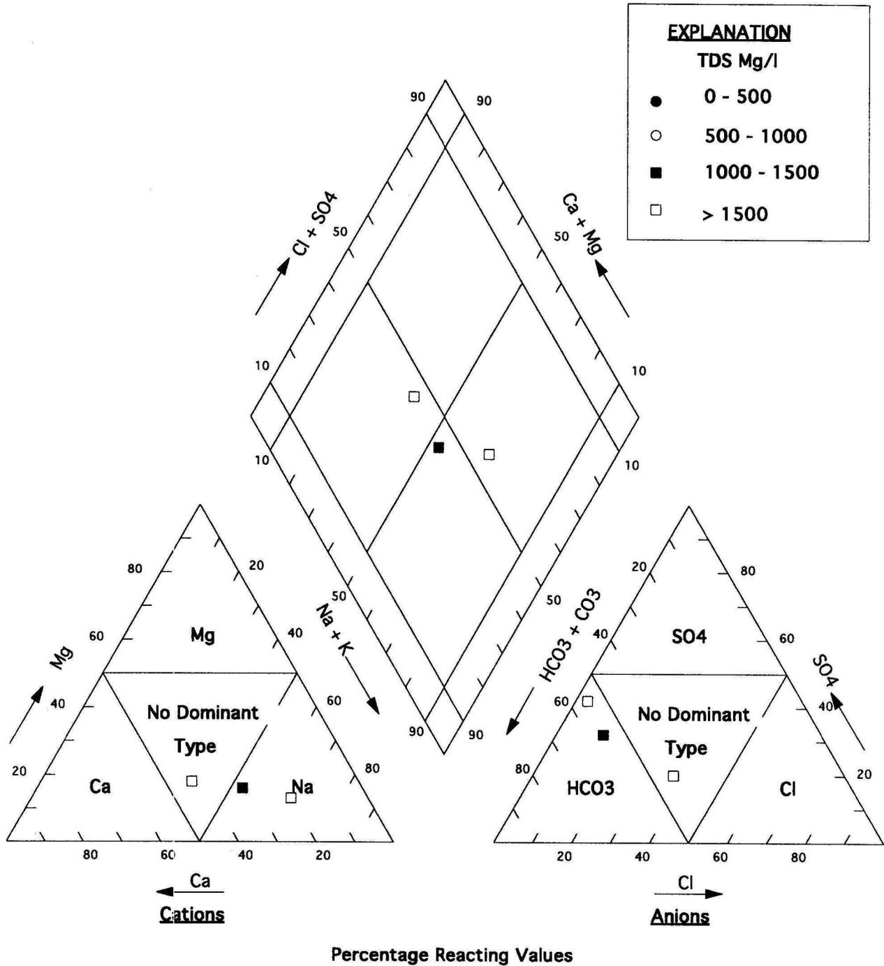
FIGURE 38. PIPER DIAGRAM SHOWING THE CHEMICAL QUALITY OF WATER FROM THE NORTHWEST BURIED-CHANNEL AQUIFER
