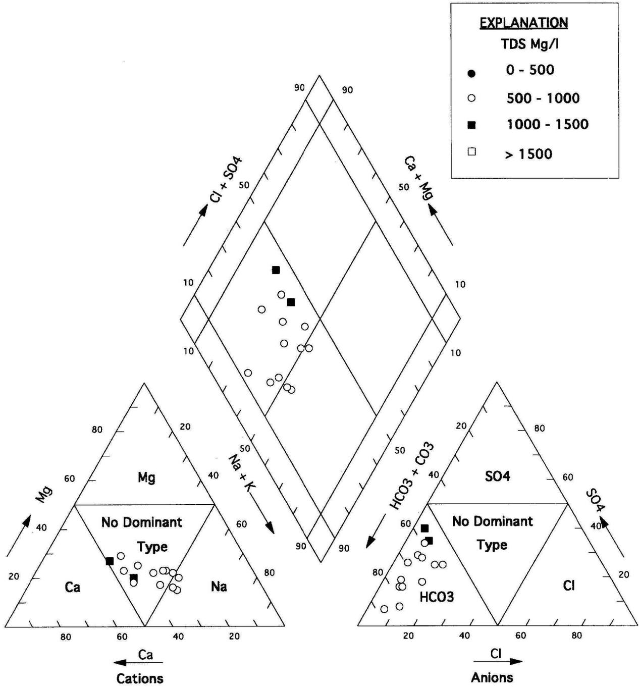
FIGURE 39. PIPER DIAGRAM SHOWING THE CHEMICAL QUALITY OF WATER FROM THE SOURIS VALLEY AQUIFER SYSTEM
